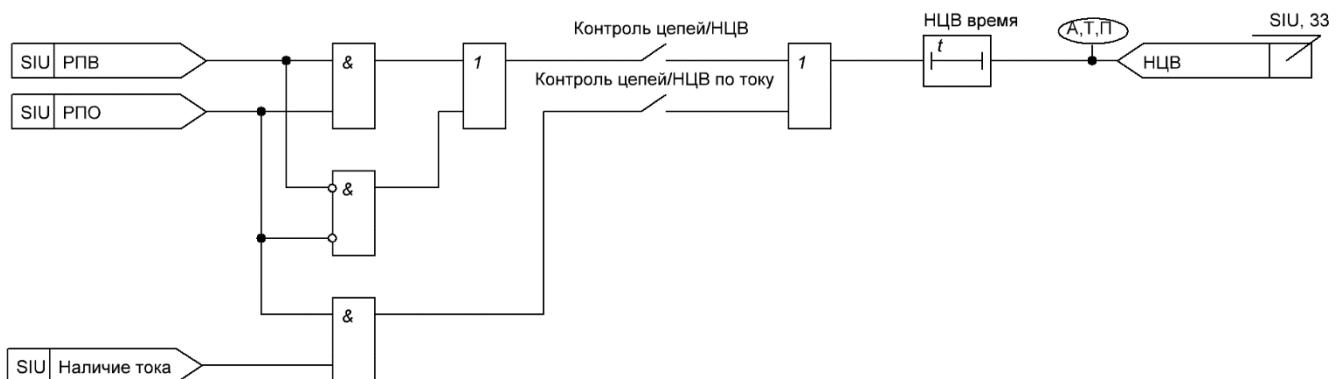
Рисунок 4.42 – Функциональная схема неисправности цепей выключателя
