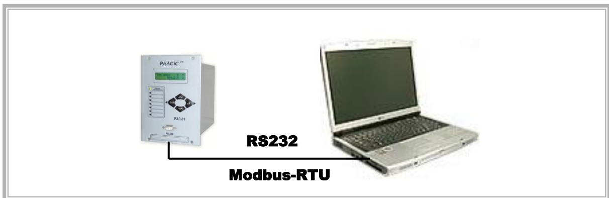
Рисунок Б.2 – Схема соединения устройства с компьютером
