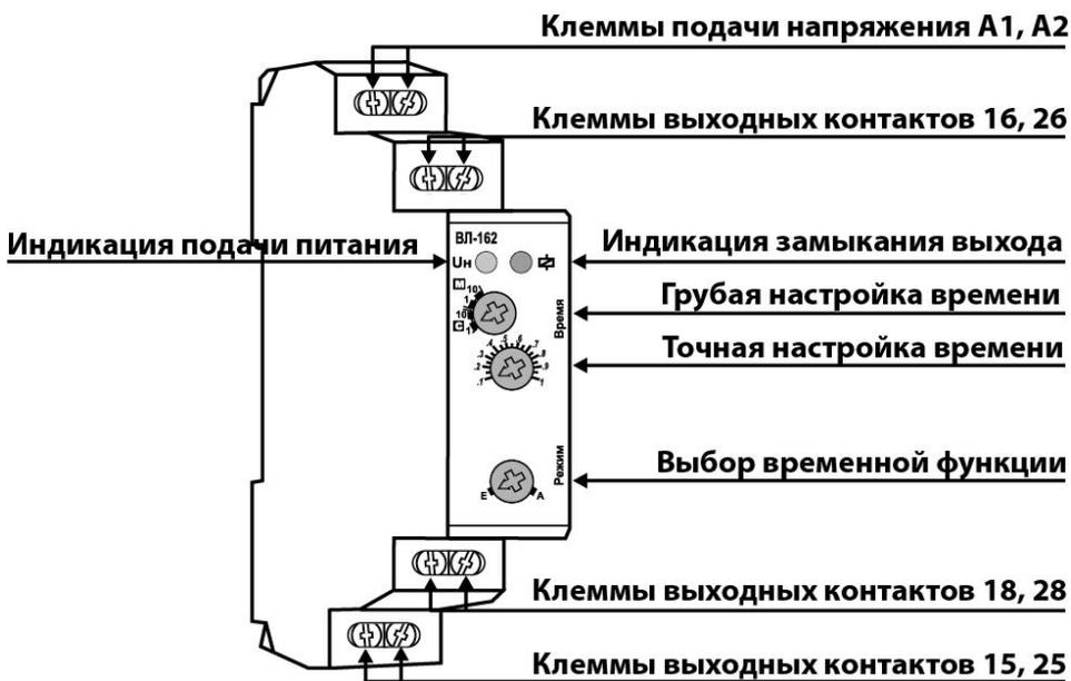
Рисунок 4 - Внешний вид реле, органы управления и сигнализации
