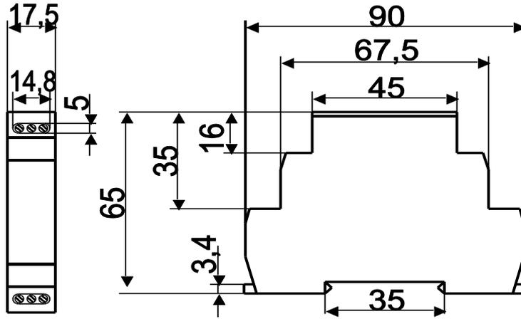
Рисунок 1 - Габаритные и установочные размеры реле
