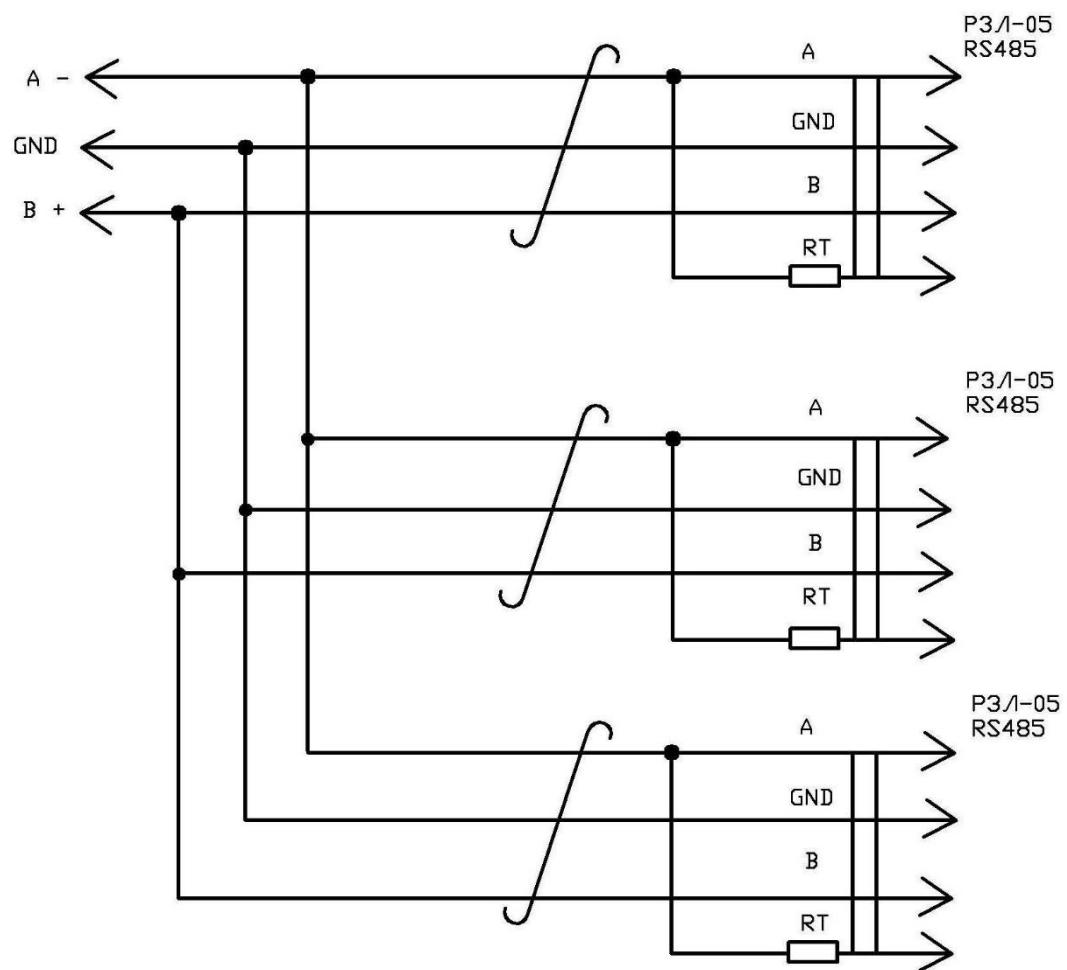
**Рисунок А.5 – Схема соединительных кабелей устройства РЗЛ-05 Ш1 ЦС.
