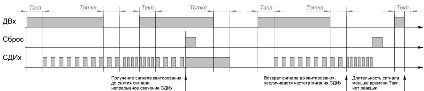
Рисунок 2 – Диаграмма работы индикации сигналов АС и ПС
