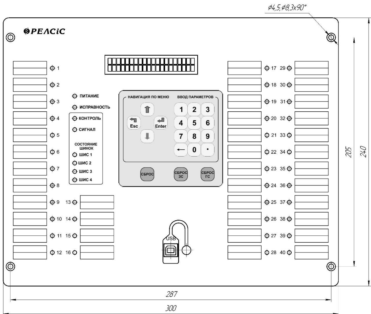
**Рисунок А.1 - Габаритные размеры и установочный размеры и внешний вид передней панели устройства РЗЛ-05.Ш1 ЦС**
