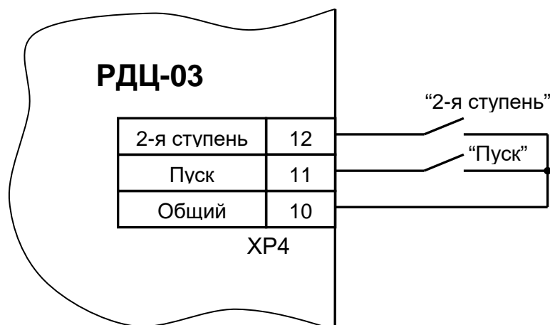
Рисунок 9 - Схема управления реле входными сигналами “Пуск” и “2-я ступень”.
