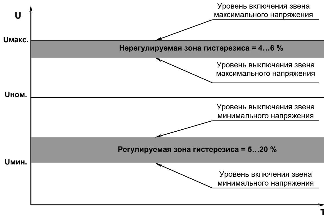
Рисунок 8 - Уровни включения/выключения звеньев максимального и минимального напряжений.
