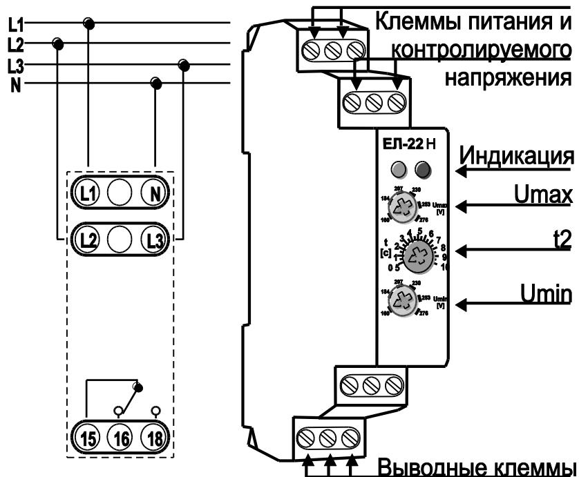
L1-N клеммы напряжения питания реле ЕЛ-21Н, ЕЛ22Н
